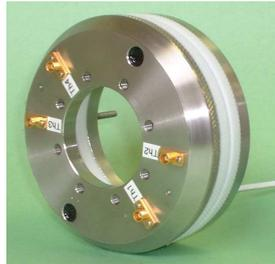
Projekt Thermosavant 4-Kanal-Temperaturmessung in Zentrifuge
