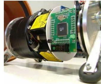
Projekt rotierende Sensorik für Kanalroboter
