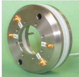
Projekt Thermosavant 4-Kanal-Temperaturmessung in Zentrifuge
