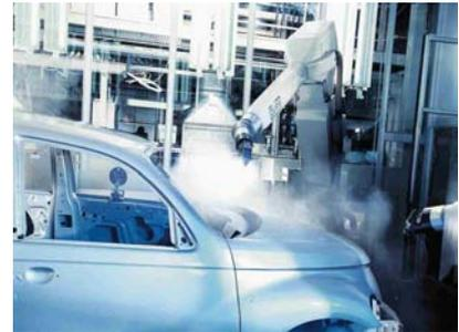
Projekt System Fahrzeug Lackierroboter
