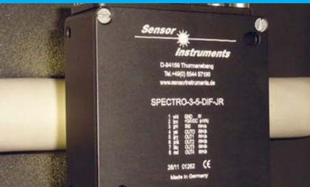
Die Isolierung von Kabeln soll in Hinblick auf Farbabweichungen kontrolliert werden. Hierbei kommt ein Farbsensor vom Typ SPECTRO-3-5-DIF-JR zum Einsatz. Der Abstand zur Kabeloberfläche beträgt dabei ca. 8 mm und der Detektionsbereich liegt bei diesem Abstand bei ca. 4 mm im Durchmesser.
