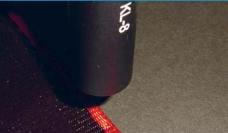
Die Farbe eines Textilbandrandes soll überwacht werden. Dazu wird ein Farbsensor Typ SPECTRO-3-FIO-CL in Verbindung mit einem Reflexlichtleiter Typ R-S-R2.1-(6x1)-1200-67° sowie einer Aufsatzoptik Typ KL-8-R2.1 eingesetzt. Der Abstand vom Optikaufsatz zur Textiloberfläche beträgt dabei ca. 15 mm und die Spotgröße liegt bei diesem Abstand bei 6 mm x 1 mm.
