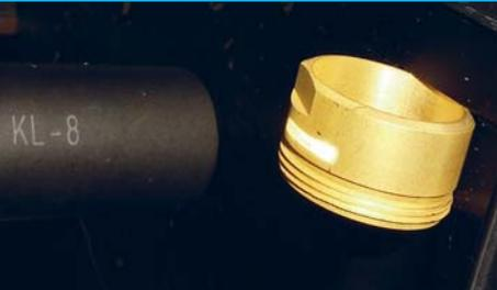
Die Beschichtung eines Drehteils aus Metall soll mittels SPECTRO-3-FIO-CL in Verbindung mit einem Reflexlichtleiter R-S-R2.1-(6x1)-1200-67° sowie einer Aufsatzoptik KL-8-R2.1 überprüft werden. Der Abstand zum Objekt beträgt dabei 15 mm und die Lichtfleckgröße liegt bei diesem Abstand bei 6 mm x 1 mm.
