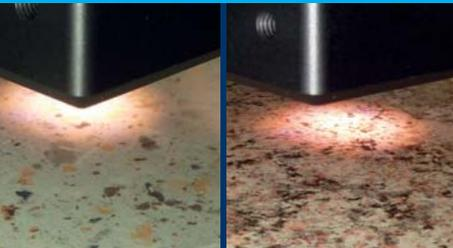
Um die mittlere Farbe von polierten Steinbodenplatten, z.B. aus Marmor oder Granit, zu ermitteln, muss zunächst der Glanz der Oberfläche kompensiert und im Weiteren optisch integriert werden, damit sich ein mittlerer Farbwert der Oberfläche ergibt. Beides wird mit Hilfe eines Farbmessensors vom Typ SPECTRO-3-28-45°/0°-MSM-ANA-VIS erreicht.
