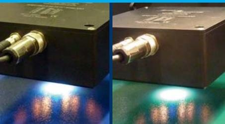
Um die Farbe von Kunststofffolien zu ermitteln wird auf einen Farbmessensor vom Typ SPECTRO-3-28-45°/0°-MSM-ANA-VIS zurückgegriffen, da mit diesem das Glanzverhalten der Folien am besten unterdrückt werden kann. Bei transparenten Folien kann außerdem auf der dem Farbsensor gegenüberliegenden Seite der Kunststofffolie eine weiße Keramikachel im Sensor-Referenzabstand angebracht werden.
