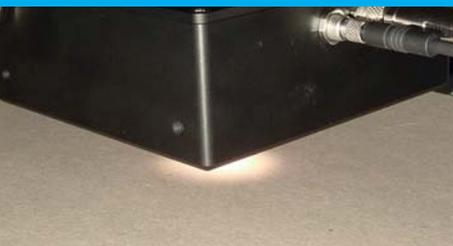
Während der Herstellung von Papier, z.B. zur Verwendung als Verpackungsmaterial, muss unmittelbar nach der Einfärbung der Papierbahn der Farbverlauf gemessen werden. Der Regelprozess wird dabei durch den Zugriff auf die Analogsignale für die  $L^*a^*b^*$ -Werte erheblich erleichtert.  $dL^*$ -,  $da^*$ - sowie  $db^*$ -Abweichungen können damit rechtzeitig auf ein Minimum reduziert werden.
