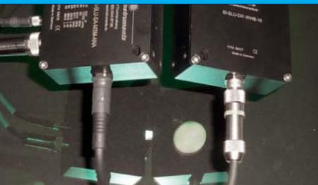
Die Farbe von beschichtetem Flachglas wird am besten mit einer gewinkelten Anordnung eines Farbmessensors vom Typ SPECTRO-3-SLU-SA-MSM-ANA sowie einer Beleuchtungseinheit vom Typ SI-SLU-DIF-WWB-16, welche diffuses Licht liefert, in Direktreflexion gemessen. Die Farbe wird dabei unter verschiedenen Einfallswinkeln gemessen, entsprechend stehen verschiedene Montagewinkel zur Auswahl.
