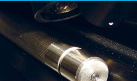
Die Präsenz einer Nut an einem Metallstab soll überwacht werden. Dazu wird ein Farbsensor vom Typ SPECTRO-3-FIO-SL in Verbindung mit einem Durchlicht-Lichtleiter Typ R-S-R2.1-(6x1)-1200-67° sowie einer Aufsatzoptik Typ KL-8-R2.1 eingesetzt. Die beiden Lichtleiterenden sind V-förmig angeordnet; der Abstand zur Objekt-oberfläche beträgt ca. 11 mm.
