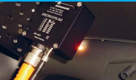
Die Farbe sowie die Intensität von LEDs, integriert in Kunststoffkomponenten für den Interieurbereich, soll überwacht werden. Hier kommt ein Farbsensor vom Typ SPECTRO-3-FCL-SLE zum Einsatz. Der Sensorabstand zur LED beträgt dabei ca. 25 mm.
