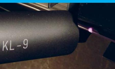
Die Farbwerte eines Kunststoffdrahtes sollen als Analogwerte (4 ... 20 mA) aus Ausgang des Sensors zur Verfügung gestellt werden. Hierbei kommt ein SPECTRO-3-FIO-SLA in Verbindung mit einem Reflexlichtleiter vom Typ R-S-A3.0-(3.0)-1200-67° sowie einer Aufsatzoptik Typ KL-9-A3.0 zum Einsatz. Der Abstand der Aufsatzoptik zur Kunststoffdrahtoberfläche beträgt dabei ca. 11 mm bei einem Lichtspotdurchmesser von ca. 1,5 mm.
