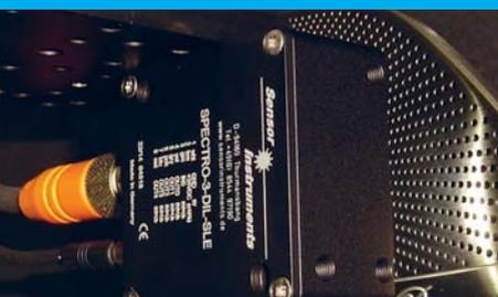
Das Vorhandensein einer Beschichtung auf einer Metalloberfläche soll kontrolliert werden. Mit Hilfe eines Farbsensors vom Typ SPECTRO-3-DIL-SLE kann die Präsenz der Beschichtung aus einem Abstand von ca. 20 mm problemlos detektiert werden.
