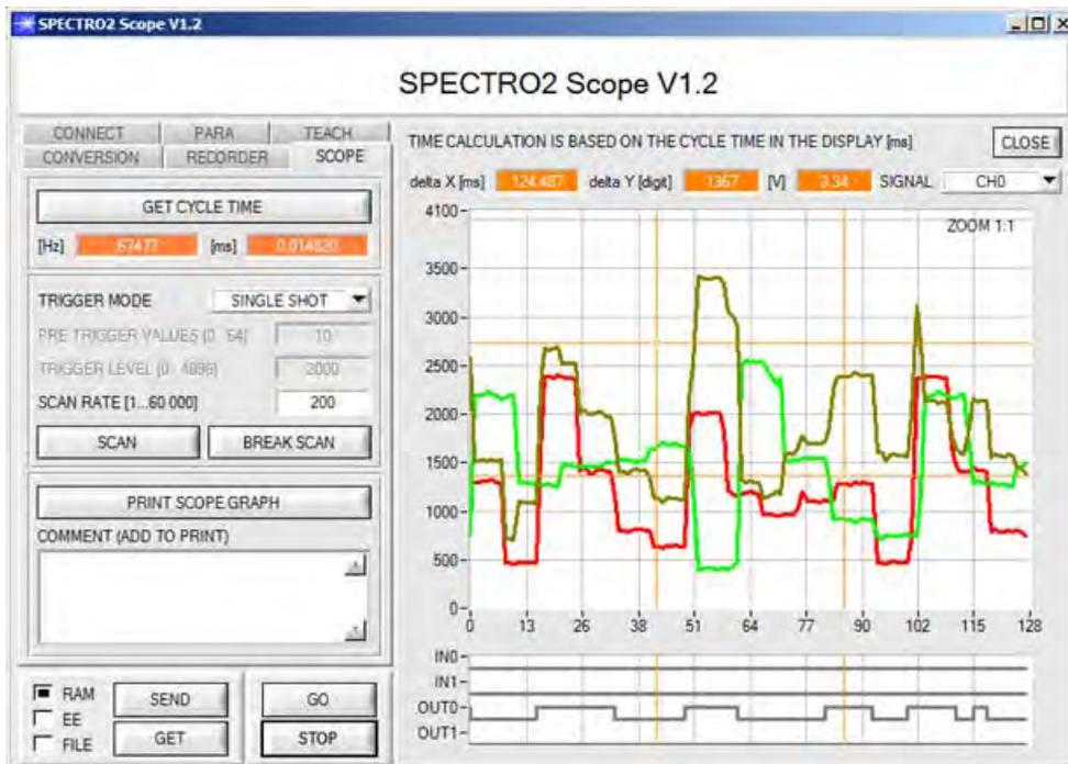
In der Registerkarte SCOPE wird ein Oszilloskop nachgebildet
